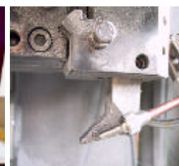
MQL applicata alle lavorazioni di torneria e di diamantatura, ditto Sabaf.
