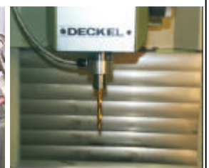
MQL interna applicata al codolo portautensile in Deckel
