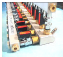
MQL applicata alla lubrificazione della lamiera
