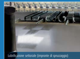
Lubrificazione settoriale (impronte di spruzzaggio)
